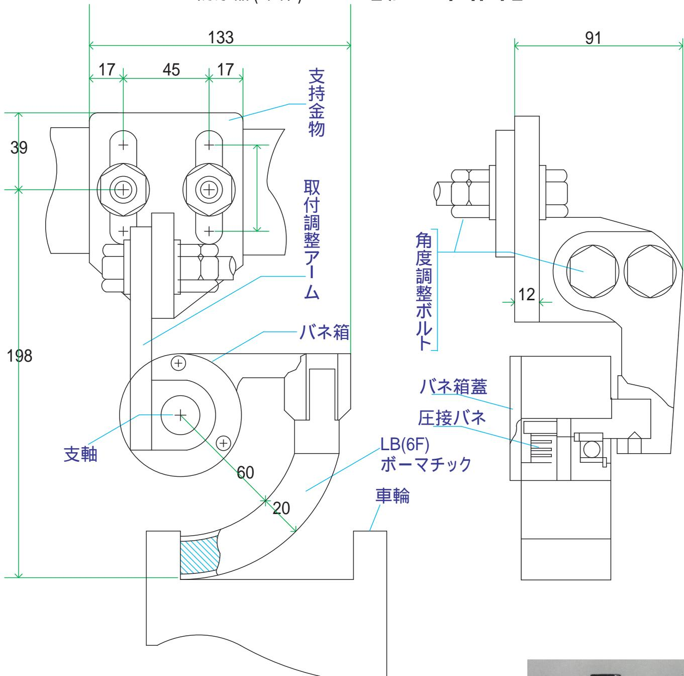
クレーン・車輪のツバ部分の磨耗防止装置です。
